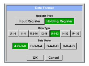
Selection Register Type Holding Register, Data Type *U1(32b)* und Byte Order *A-B-C-D* **HWord** LWord HByte LByte HByte LByte 29235175522 => ΑE 41 56 Data Order 1.Byte 2.Byte 3.byte 4.Byte A-B-C-D ΑE 41 56 52 D-C-B-A 52 56 41 ΑE B-A-D-C 41 ΑE 52 56 C-D-A-B 56 52 ΑE 41
